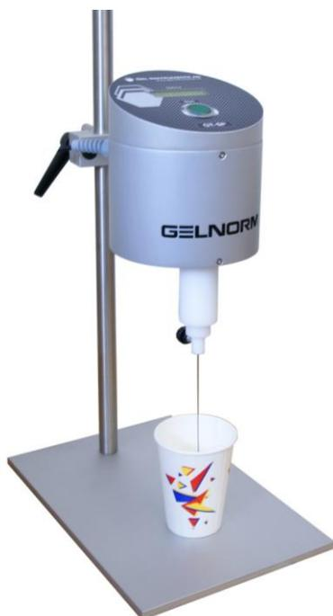
Der GT-SP Slim Line Geltimer mit integriertem Steuer- und Zeitmessgerät ist das kompakte Nachfolgemodell vom Geltimer TC.
